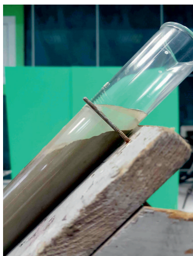
Rys. 1. Nadmierne frakcjonowanie zaczynu
