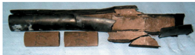
Rys. 3. Stan baterii rdzeni oraz rękawa po przeprowadzonych badaniach laboratoryjnych. Pierwsza część – zatłaczanie CO 2 , druga część – zatłaczanie H 2 S (zdjęcia wykonane w Zakładzie Badania Złóż Ropy i Gazu)
