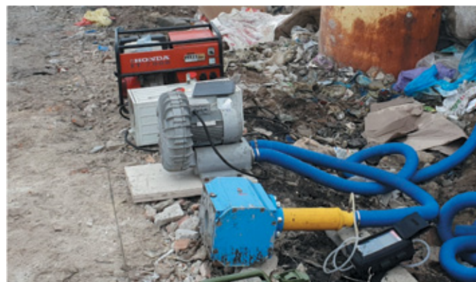
Rys. 1. Zestaw do dynamicznego odbioru gazu ze składowiska Fig. 1. A set for dynamic gas collection from a landfill
