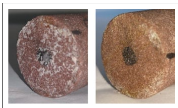
Rysunek 14. Próbką C20 po końcowym pomiarze przepuszczalności i po oddziaływaniu HCl
