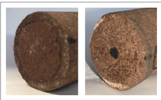
Rysunek 17. Próbką C41 po końcowym pomiarze przepuszczalności i po oddziaływaniu HCl
