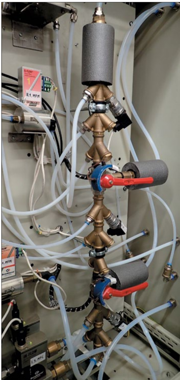
Rysunek 1. Innowacyjny, modułowy, segmentowy mieszalnik gazów opracowany przez pracowników INiG – PIB
