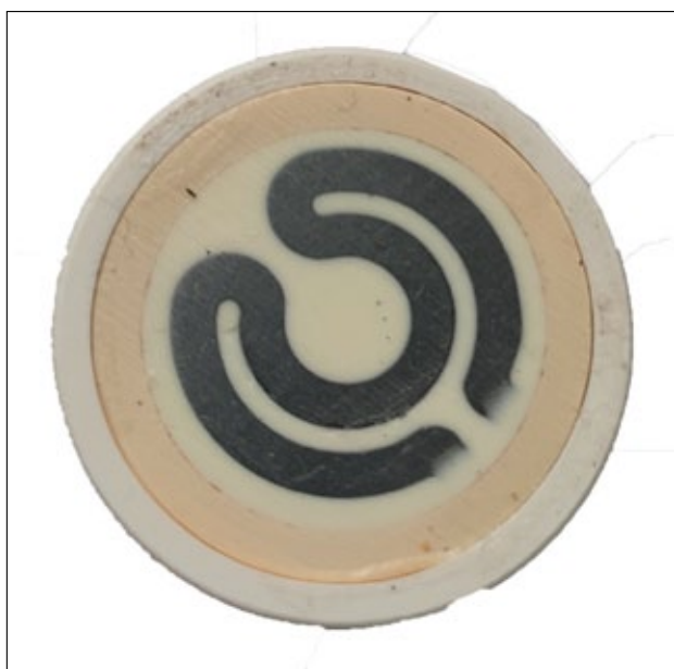
Rysunek 5. Widok powierzchni eksponowanej nowego czujnika korozymetrycznego (fot. T. Minor)
