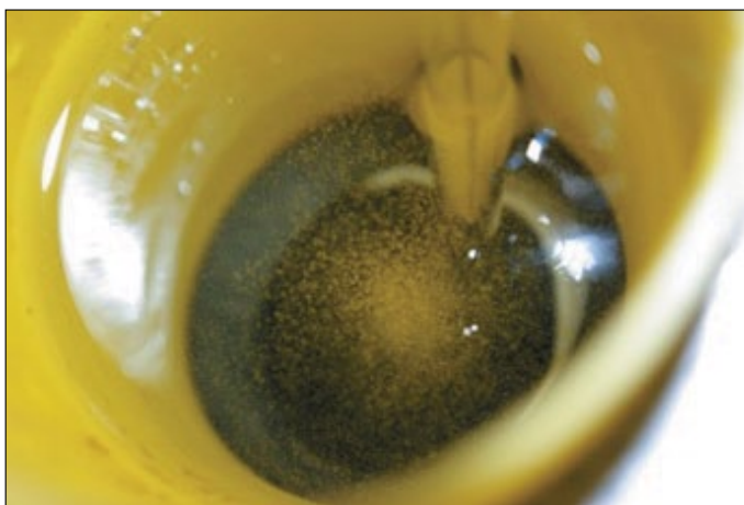
Rysunek 3. Widoczny efekt wodorowania przy potencjale poniżej -1420 mV (fot. T. Minor)
