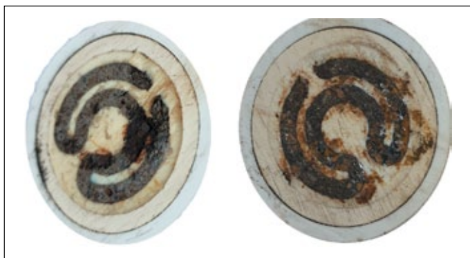
Rysunek 17. Z lewej strony widok zdemontowanego czujnika nr 1574/20 polaryzowanego potencjałem -650 mV w gruncie o rezystywności <30 \Omega\text{m} ; z prawej strony widok zdemontowanego oczyszczonego czujnika nr 1598/20 niepolaryzowanego umieszczonego w gruncie o rezystywności <30 \Omega\text{m}
