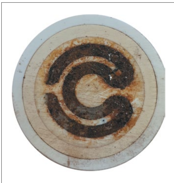
Rysunek 18. Widok zdemontowanego oczyszczonego czujnika nr 1601/20 niepolaryzowanego umieszczonego w gruncie o rezystywności >1000 \Omega\text{m}
