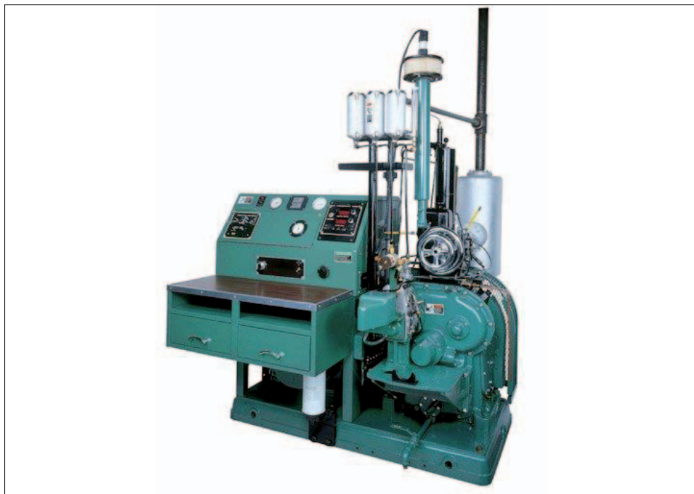
Rys. 56. Stanowisko silnikowe do oznaczania liczby cetanowej
