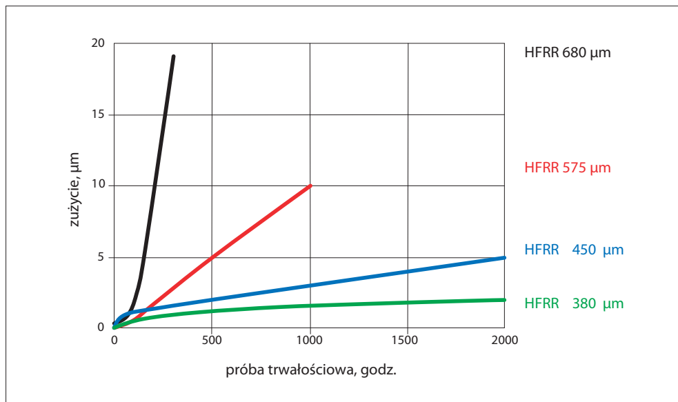
Rys. 79. Korelacja smarności oleju napędowego i trwałości pompy wtryskowej dla olejów napędowych o różnej smarności [223]
