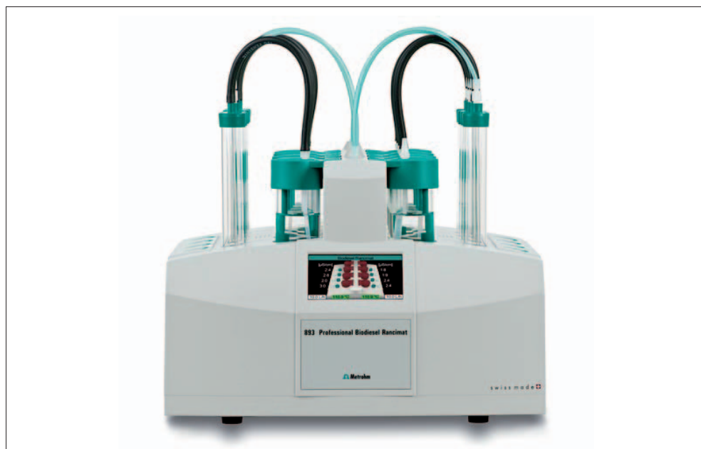
Rys. 55. Profesjonalny aparat Rancimat do oznaczania stabilności oksydacyjnej
