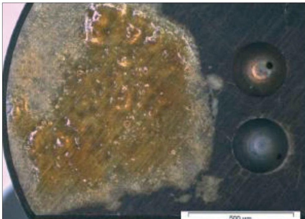
Rys. 35. Organiczny osad amidowy wyprodukowany w warunkach laboratoryjnych w reakcji wodorotlenku sodu i PIBSI [155]
